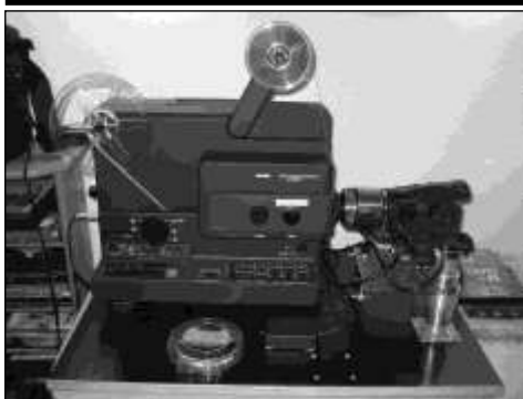
Ein Bauer T610 Projektor wurde für das qualitative Abtasten der S-8 Filme mit sync-dc umgebaut.
